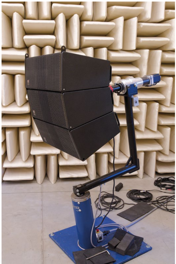
3er-Array an der ELF-Maschine zur Messung des Abstrahlverhaltens in Abhängigkeit vom Winkel der Boxen zueinander. Es wurde mit Box-to-Box-Winkeln von 0°, 6° und 12° gemessen
