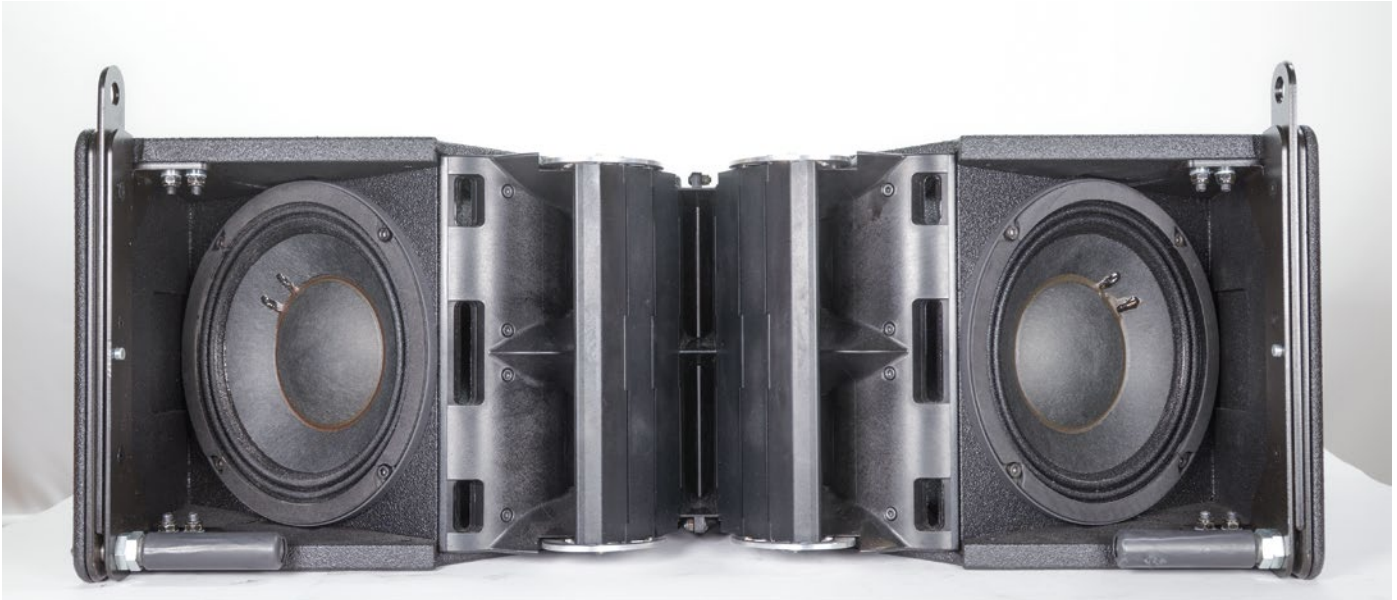
Öffnungen an den Seiten der Mittel-Hochtoneinheit als Bassreflex Ports der Mitteltöner in der Sequenza 8, seitlich unten sind die Federbolzen des AutoLock-Rigging-Systems zu erkennen
