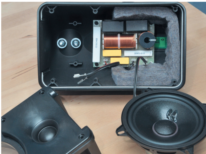
Eine zerlegte Sona 5: Das Gehäuse besteht aus der Frontplatte und der eigentlichen Gehäuseschale. Beide Teile sind aus flammgeschütztem Kunststoff gefertigt.
