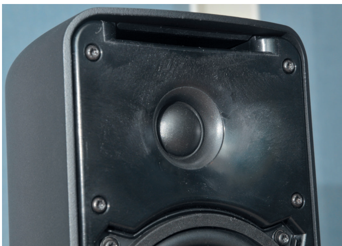
Hochtonkalotte mit einem in die Frontplatte integrierten Waveguide zur Kontrolle des Abstrahlverhalten und zur Erhöhung der Sensitivity des Hochtöners.
